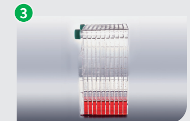
将CellFac®细胞工厂缓慢翻转90度,带有进液口的一面在上,静置后培养基会平均分配到每一层
