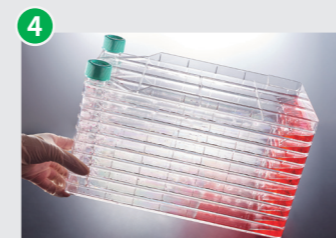
手握住进液口的一面,缓慢将CellFac®细胞工厂倾斜放倒,变为水平放置,放入细胞培养箱中孵育培养
